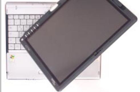
Convertible-Konzept: Das Display lässt sich drehen und auf die Tastatur legen - fertig ist der Tablet-PC!
